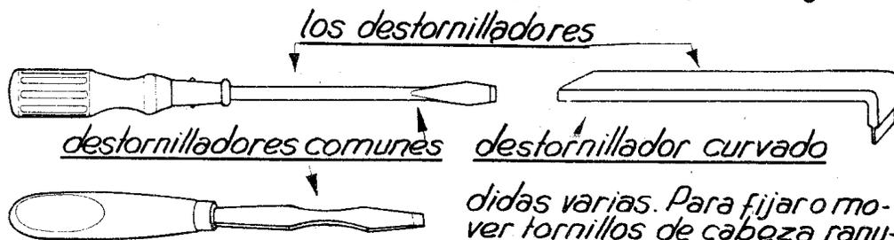
distintas. Para fijar o mover tornillos de cabeza ranurada, se usan los destornilladores, constituidos por un vástago afilado en un extremo y con un cabo en el otro.
