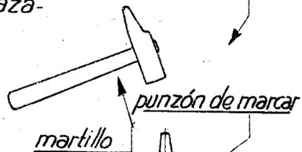
punteado de una pieza trazada.
